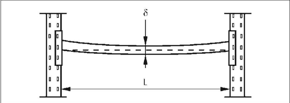
Figura 13 - Deformazione della trave ( $\delta$  = freccia in mezzzeria)
