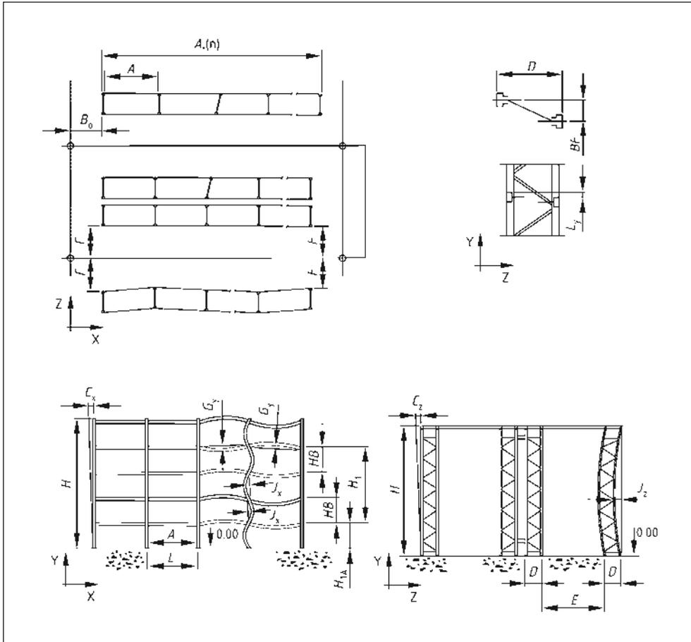
Figura 11 – tolleranze di installazione orizzontali e verticali
