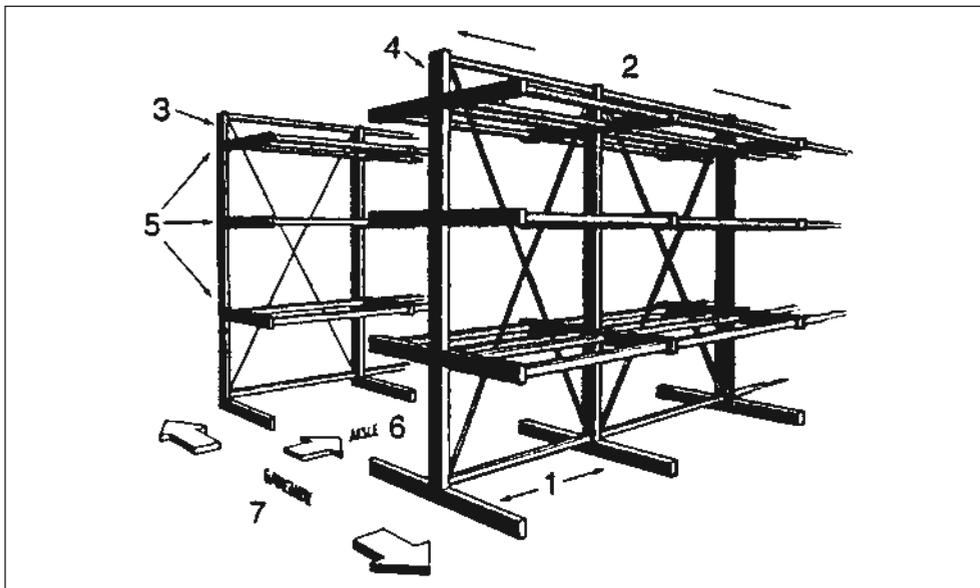
Figura 4 - Scaffalatura Cantilever verticali (fi gura 3).
